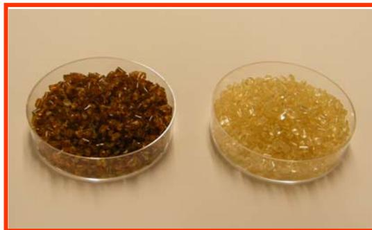
Materiales polimericos polimida y polisulfona para fabricación de membranas
